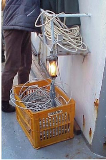
Sarkıtılmaya hazır, altında ağırlıklar bağlı, sızdırmaz su altı ışık kaynağı
